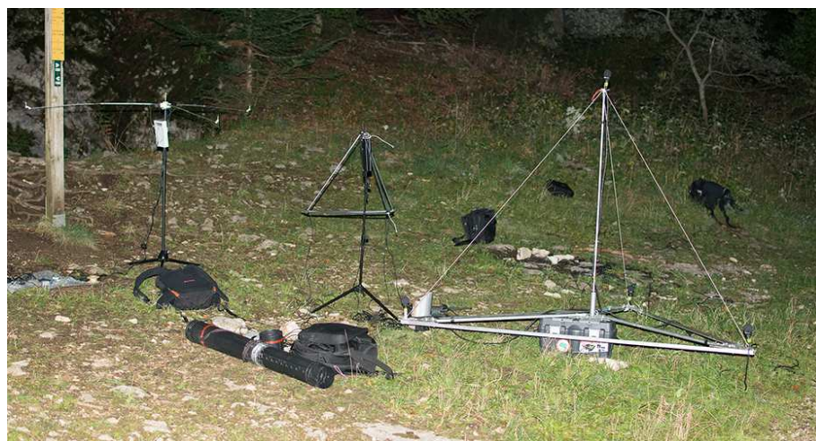
Trois équipements différents pour la triangulation. Les récepteurs sont tous conçus sur le principe d'un microphone fixé à chacune des 4 extrémités d'un tétraèdre. Les microphones sont reliés à un équipement informatique qui permet de déterminer les différences de temps d'un même signal arrivant sur chacun des 4 micros. A gauche, un équipement utilisé par le MNHN (Y. Bas), au milieu par l'université des sciences de Toulon (H. Glotin) et à droite par la société Cyberio (M. Charbonnier et D. Mauuary). Photo : CC BY SA O. Picard.
